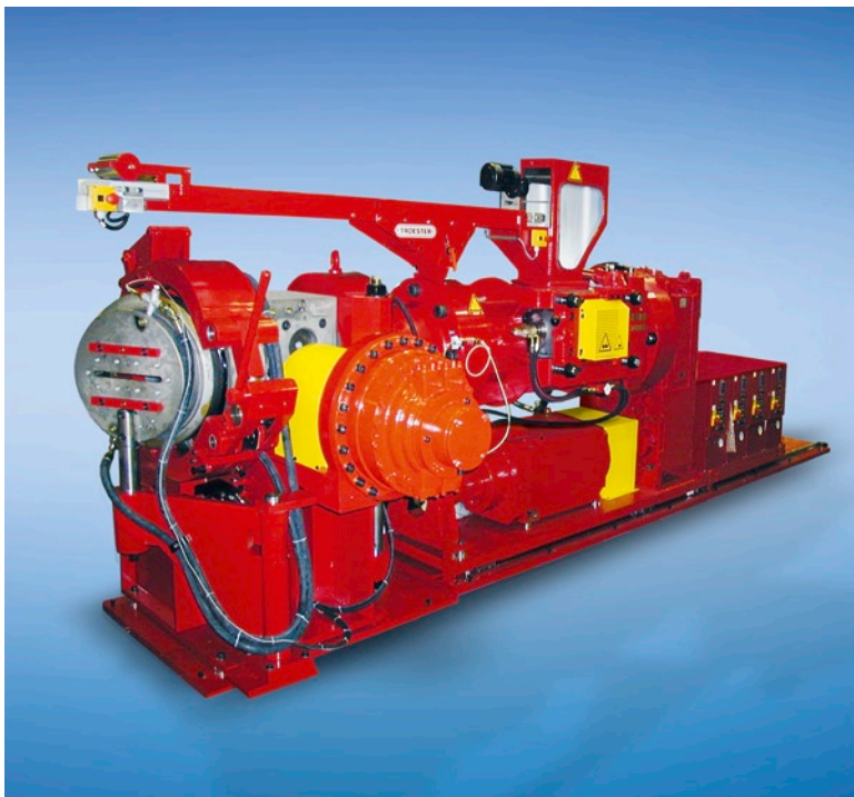
TROESTER-Extruder Typ GS-250w-6D mit Zahnradpumpe ZP 200/135
