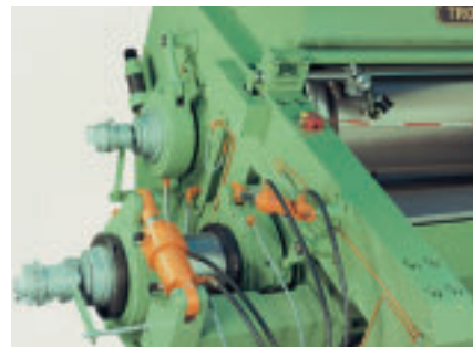
Walzenvorbelastung und Gegenbiegung Roll pre-loading and roll bending
