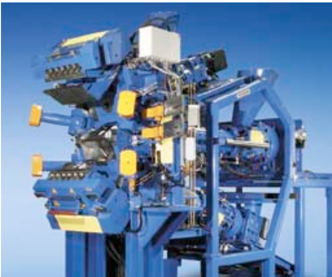
Mehrfach-Extrusionsaggregate mit Hammer- oder Klammerkopf-Ausführungen Multiple extrusion aggregates with hammer or clamp head design
