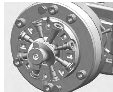
Schematische Darstellung des Querstrom-Mischzylinders
